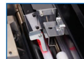
El Escáner CCD lee códigos de barras para llamar trabajos almacenados y marcas de registro para corregir el desplazamiento de imagen.
