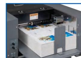
La bandeja de alimentación por succión de aire previene marcas en las hojas, además de doble y falta de alimentación. La cuchilla de aire ayuda a la separación de papel.
